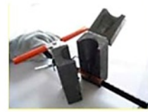
Paso 8, abrir y extraer la soldadura
