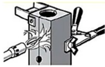
Paso 6, cerrar la tapa y accionar el fósforo ignitor
