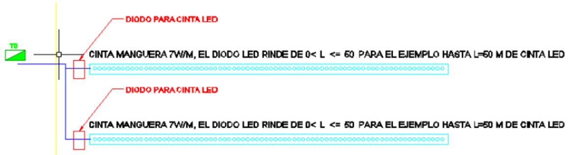
Imagen 2. Esquema de conexión del Diodo para cinta led de neón
