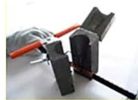
Paso 8, abrir y extraer la soldadura
