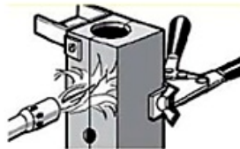
Paso 6, cerrar la tapa y accionar el fósforo ignitor
