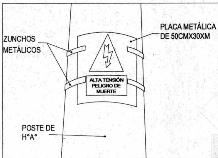
Ilustración 1 Detalle de propuesta de sujeción
