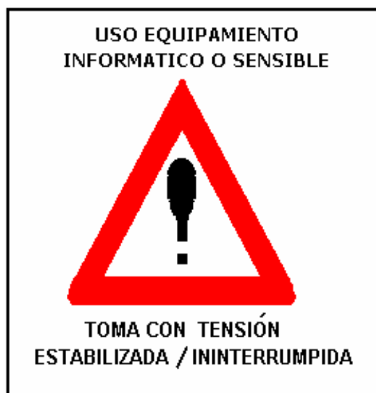
Figura 2 Logotipo que debe tener un tomacorriente del circuito ATE
