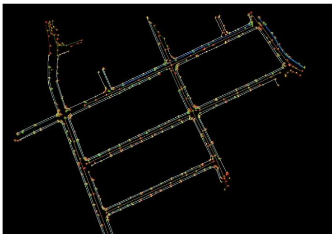
Fig. 70- Importación de la edición a AutoCAD Civil 3D Land 2009
