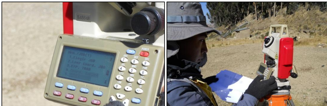
Fig. 19- Introducción de datos a la Estación Total
