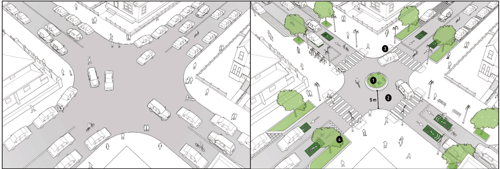
Ilustración 24 - Intersección tipo calle - calle
