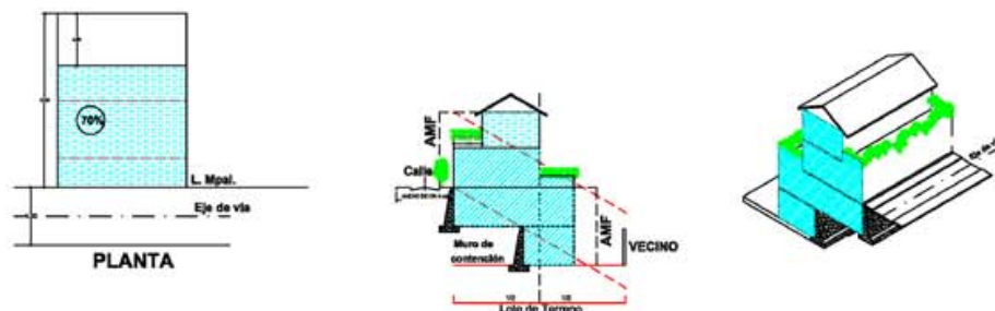
e EJEMPLO GRAFICO DEL PATRON 1 EN VIAS MENORES A 4 METROS CON PENDIENTE POSITIVA
